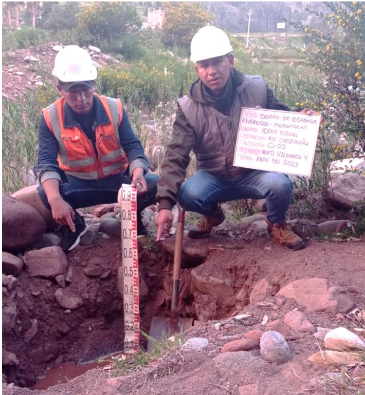
Fuente: El autor. (2023). Calicata 02
