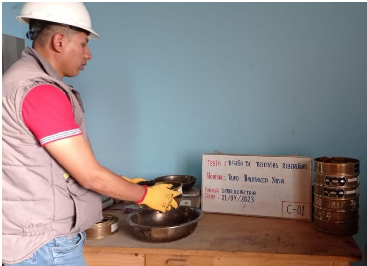
Figura 97. Tamizado de la muestra calicata 03
