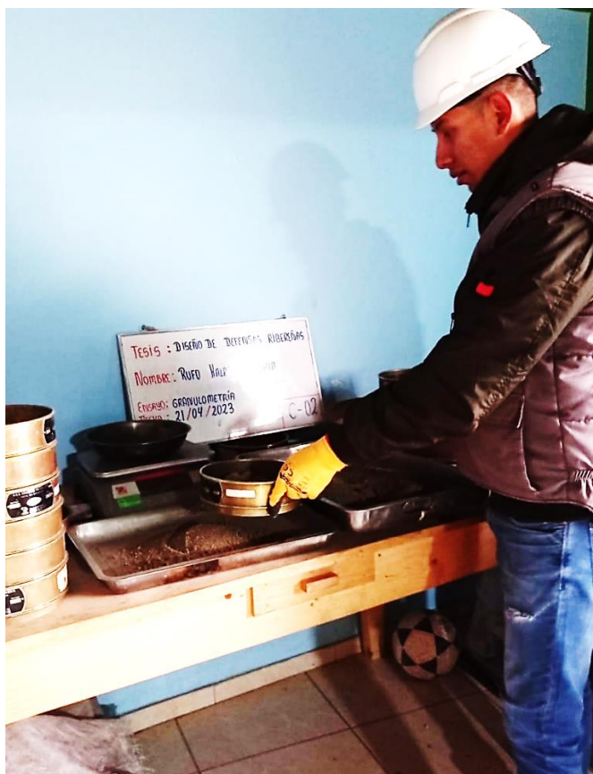
Figura 96. Tamizado de la muestra calicata 02
