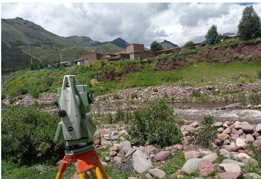
Figura 46. Método de levantamiento, con estación total
