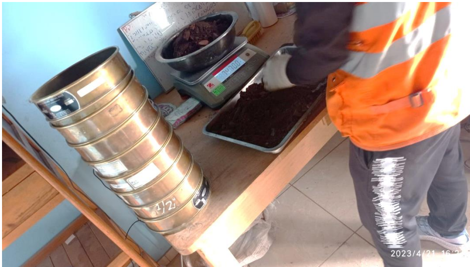
Figura 91. Cuarteada de las muestras de suelo para el tamizado
