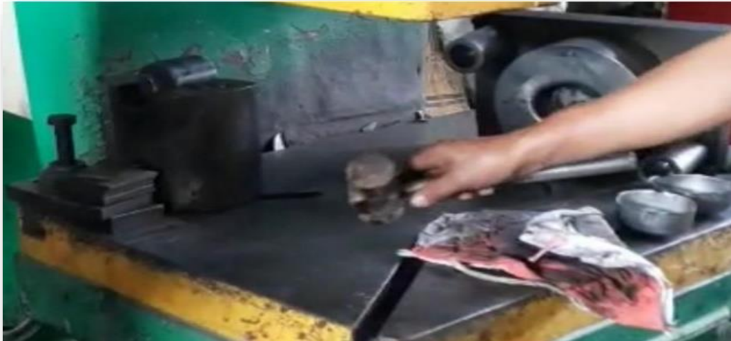
Figura 206 Movimiento de martillo para instalar la matriz
