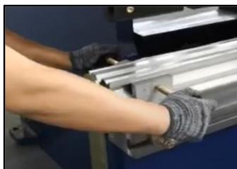
3. Aflojar los tornillos de ajuste (7) y mover el tope de recubridor L hacia arriba o abajo para ajustar.
