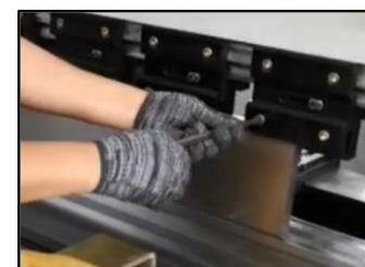
7. Mover el tornillo de ajuste (3) hacia arriba o abajo a lo largo de la ranura para ajustar.
