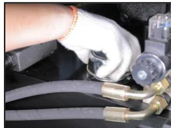
4) Sujetar la porción de vidrio del fusible a reemplazar y extraiga el fusible.
