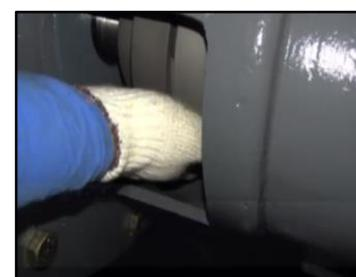
7. Cerrar la tapa posterior mientras que presiona el lado inferior de la tapa posterior, sección A, y apriete los cuatro tornillos.
