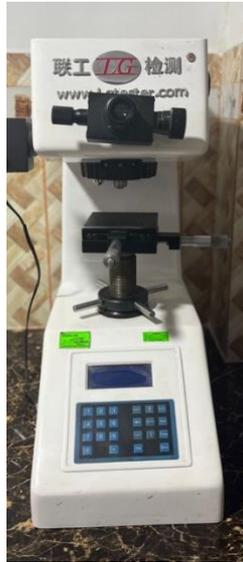
**Imagen N°3 Microdurómetro de Vickers**
