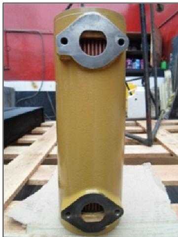
**Figura N°28.** Enfriador de aceite hidráulico tubular
