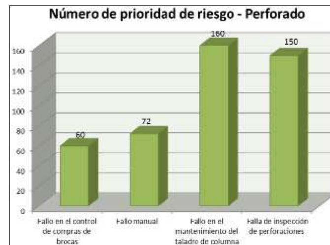
Figura N°48. NPR inicial del proceso de perforado
