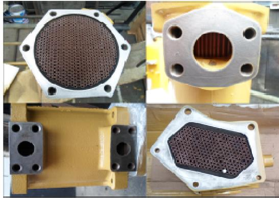
**Figura N° 39.** Enfriadores de aceite tipo tubular
