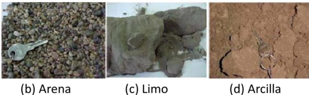
Nota: En la siguiente figura se pueden apreciar referencialmente la comparación entre los tamaños de arena, limo y arcilla. Fuente: Los autores
