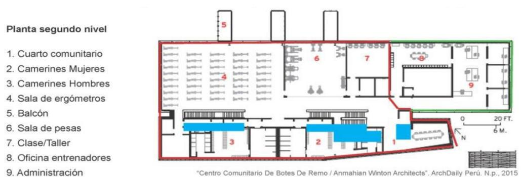
**Figura 32:** Planta segundo nivel.
