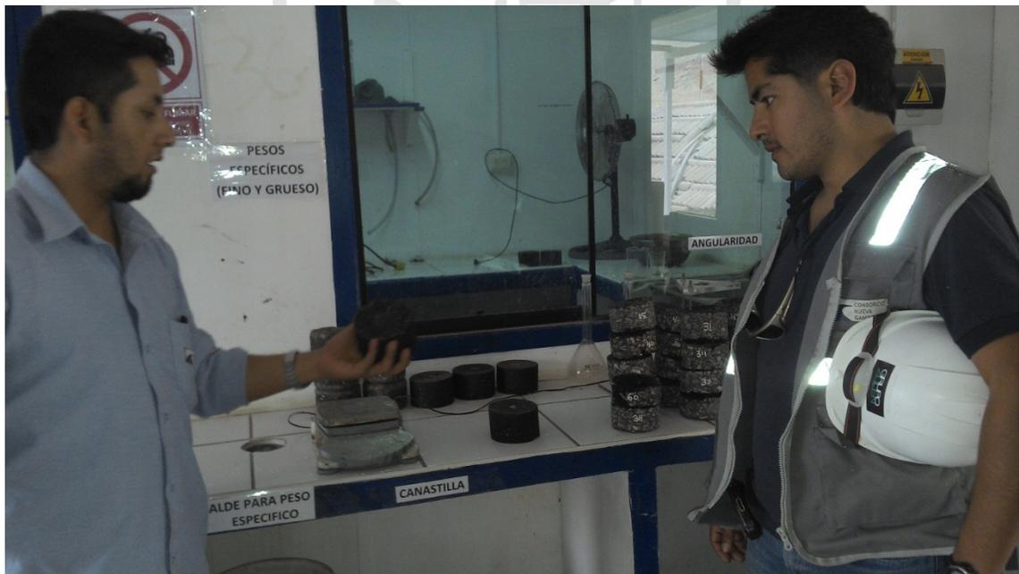
**Figura N° 12: Probetas Marshall desmoldadas**
