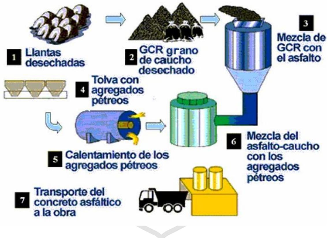
Figura N °8: Esquema de fabricación de asfalto caucho por vía húmeda.
