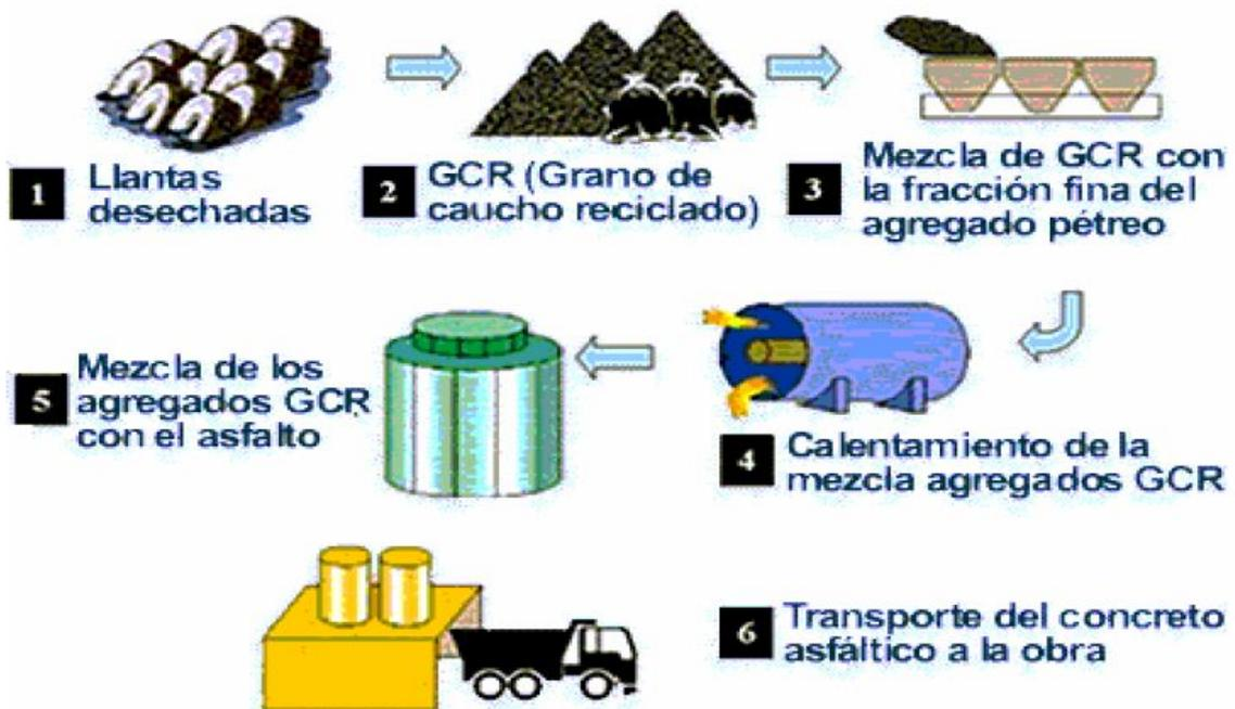
**Figura Nº 9: Esquema de fabricación de asfalto caucho por vía seca**
