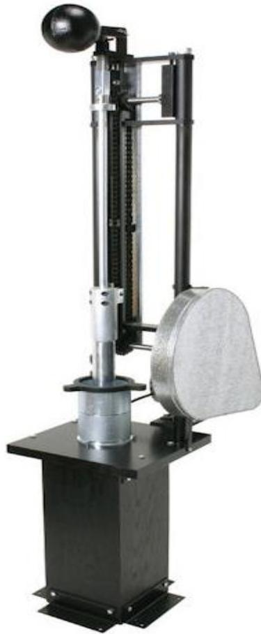
**Figura N° 6: Equipos para laboratorio. Martillo Marshall**
