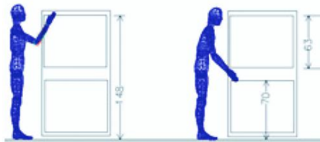
Figura 49. Alturas de acceso fila superior e inferior en los armarios fijos de máquinas textiles.
