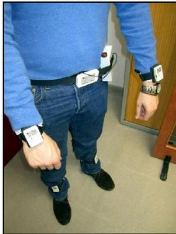
**Figura N° 30.** Sensores Portátiles.
