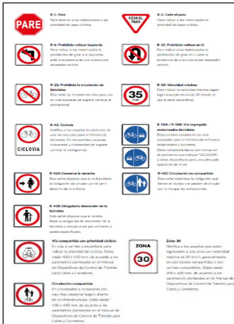
**Figura 35.** Señales reglamentarias vigentes y recomendaciones de aplicación en infraestructura ciclovial.
