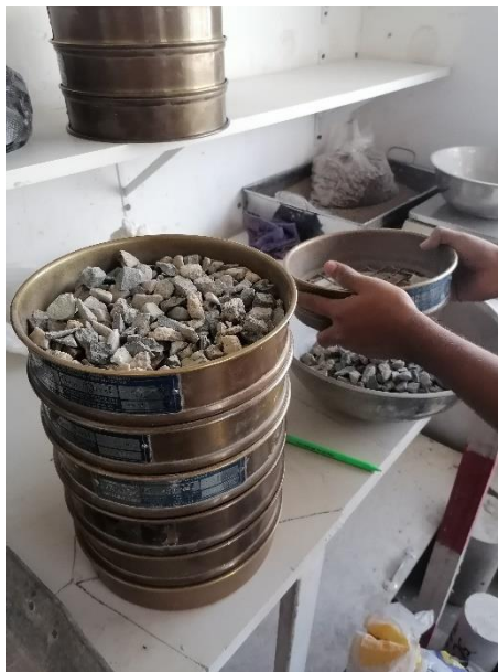
Figura 7 Ensayo Granulométrico – Agregado Grueso
