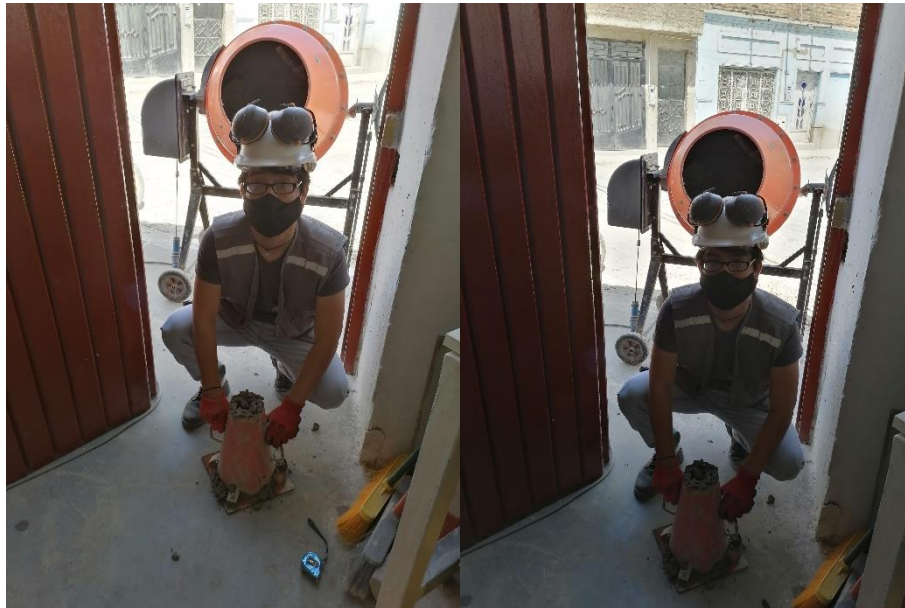
Ensayo de Asentamiento para Dosificación 01 y 02.
