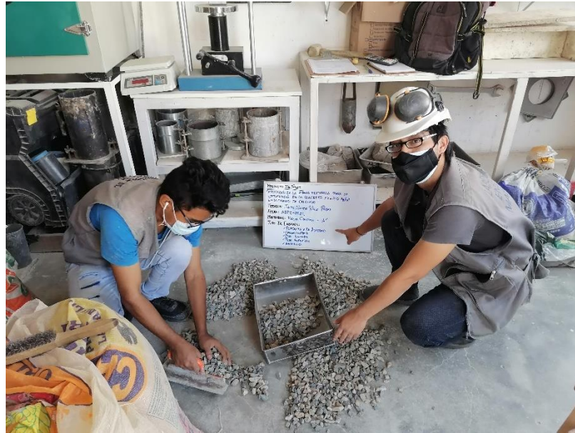
Figura 6 Ensayo Granulométrico – Agregado Grueso
